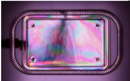
Bauteilsicht durch Polarisationsfilter
