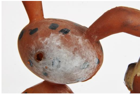
Spielzeugfigur „Marsupilami“ mit weißen Rückständen, genannt Ausblühung (Polyvinylchlorid) (© TH Köln)
