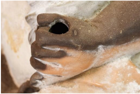
Ausschnitt eines Gartenzweigs aus Polyvinylchlorid (PVC) mit brauner Verfärbung (© TH Köln, CICS, Lisa Burkart 2020)
